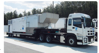
移動式大容量発電機 ▶
