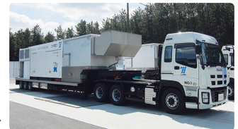
移動式大容量発電機 ▶
