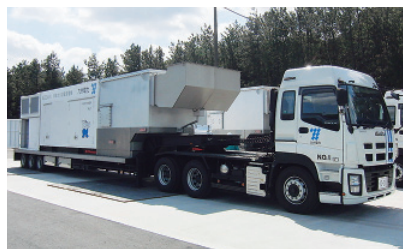
移動式大容量発電機
