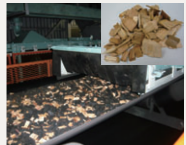
コンベア上の石炭と混ぜられた木質チップ(粉砕前)
