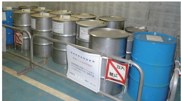
PCB廃棄物の保管・管理状況
