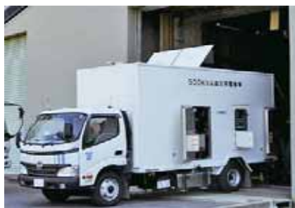
高圧発電機車
