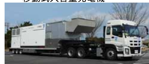
移動式大容量発電機
