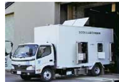
移動式大容量発電機
