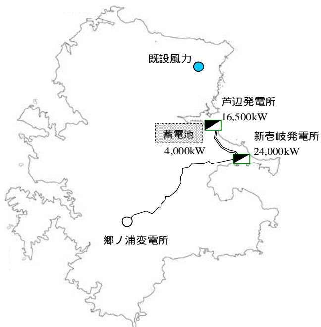
実証離島（壱岐）の電力系統
