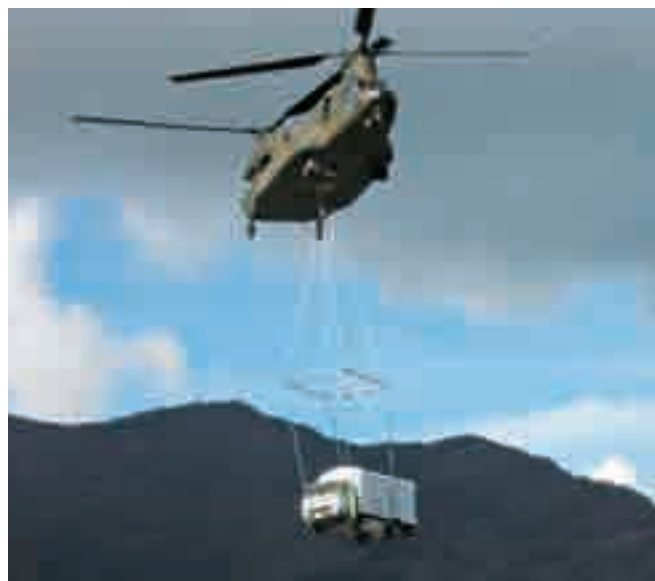
高圧発電機車の空輸
