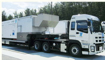
② 移動式大容量発電機
